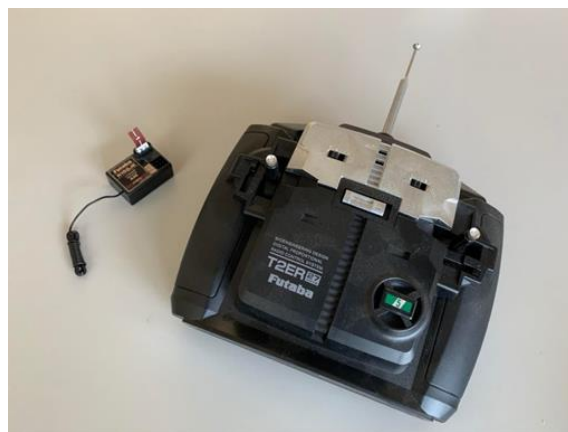
市售 3 通道 27MHz 板型遙控收發器
